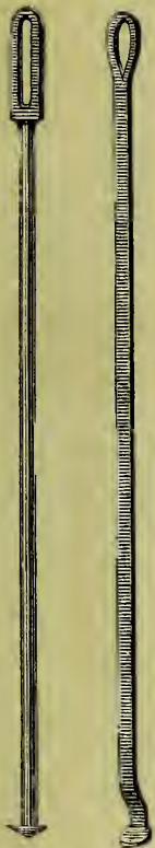
Fig. 62. — Cures pour nettoyer les trous de mine.
